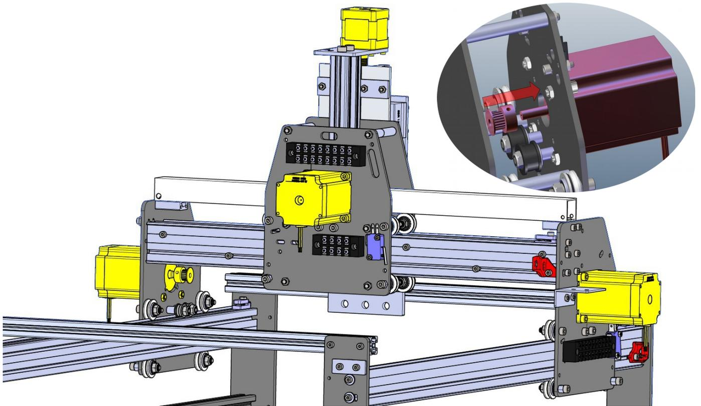
Les moteurs des axes X et Y sont livrés avec des poulies aluminium correspondant au profil des courroies de transmission déjà présentes, c'est à dire profil GT2 et pas de 2mm.
